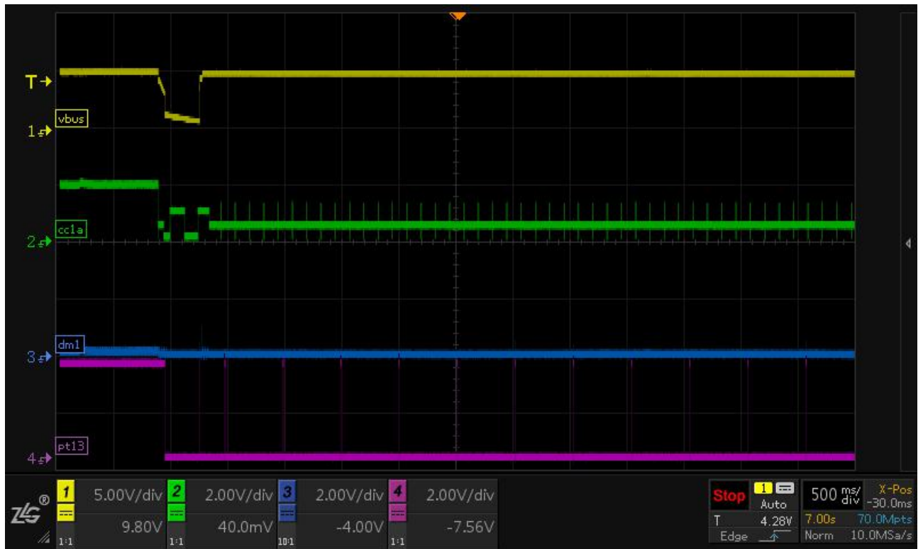
图 5 C-C 带载休眠功能测试波形
