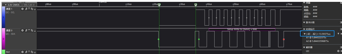
SDA 和 SCL 同时由高变低时序图
